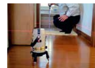
室内のポイントごとに水平測定
