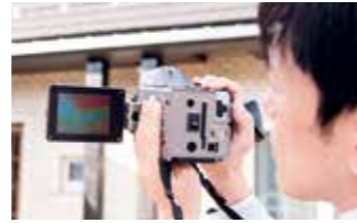
サーモグラフィカメラ / 視覚的に温度診断を行い、外見の目視確認では分からない内部の水漏れを発見します。
